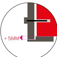
LARGEUR ÉBRASEMENT = LARGEUR DU MUR + 5MM
