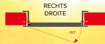
Deurblad zowel rechts- als linksdraaiend plaatsbaar / Pose de la porte avec sens d'ouverture gauche ou droit
