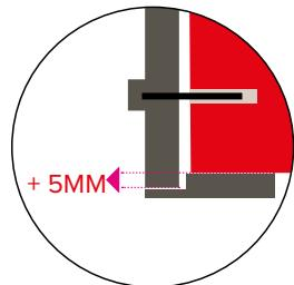
LARGEUR ÉBRASEMENT = LARGEUR DU MUR + 5MM
