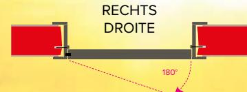
Deurblad zowel rechts- als linksdraaiend plaatsbaar / Pose de la porte avec sens d'ouverture gauche ou droit
