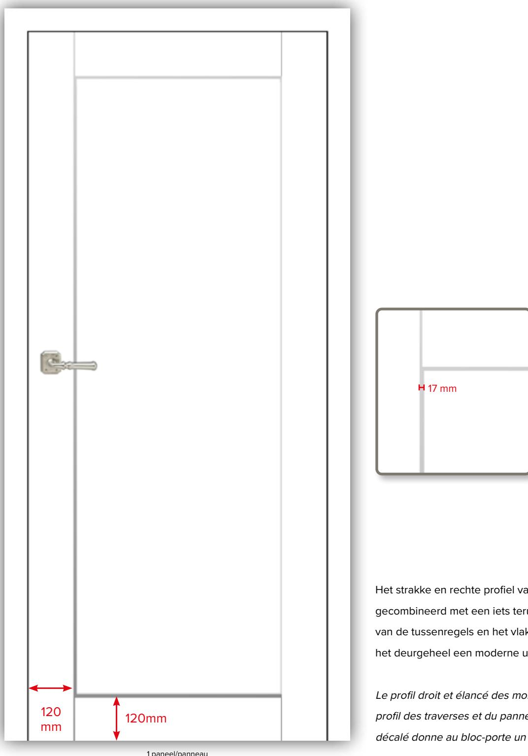
Het strakke en rechte profiel van de stijlen, 12 cm, gecombineerd met een iets terugvallend profiel van de tussenregels en het vlakke paneel geven het deurgeheel een moderne uitstraling.
