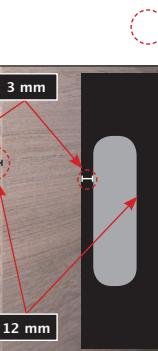
**4. Fixez l'ébrasement COTE CHARNIERES au moyen des 4 vis de distance réglable THYS et d'un long niveau afin que l'ébrasement soit parfaitement perpendiculaire et plat dans l'ouverture murale.**
