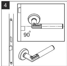
**4** Montez la béquille extérieure (avec clavier) sur la porte. Assurez-vous que la béquille soit maintenue horizontalement au cours de l'installation.
