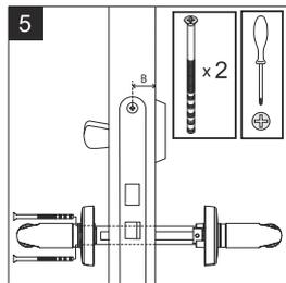
**5** Fixez la béquille extérieure à la béquille intérieure. Vérifiez que la pose des béquilles soit correcte, en actionnant les deux béquilles.
