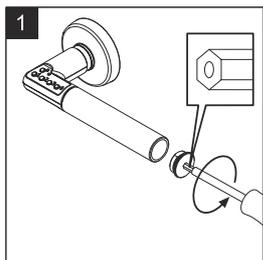
**1** Dévissez le couvercle de la pile ouverte avec le tournevis.
