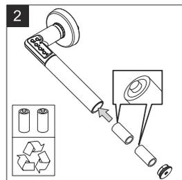
**2** Poussez le levier vers le bas et laissez passer les deux piles. Insérez deux nouvelles piles dans le bon sens.
