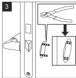
**3** Placez la béquille intérieure sur la porte et la fixer sur la porte à l'aide des vis traversantes. Coupez les vis à mesure (des encoches sont prévues), la vis doit dépasser de la porte de maximum 6 mm.
