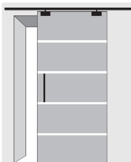
2/ Vous clipsez ensuite les clips sur le cache-rail en aluminium à distance égale. Vous vissez dans les 4 ouvertures prévues dans les clips et fixez contre le mur.
