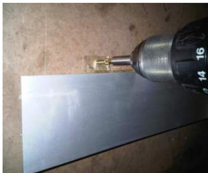
3/ Vous montez, si nécessaire, le chant de finition à l'aide des supports en plastique.
